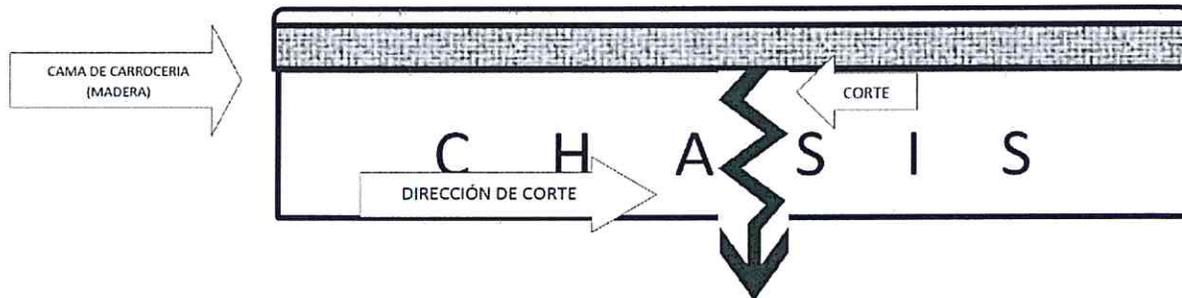
LA VISTA SUPERIOR REPRESENTA LA SECCIÓN DEL CHASIS DISPUESTA SOBRE LOS EJES DEL AUTOMOTOR, EN EL CUAL SE APLICARÁN CORTES PARA LA INHABILITACIÓN DE LAS UNIDADES INDICADAS EN LA PRESENTE LICITACIÓN. EN EL ESQUEMA SE MUESTRA DE IGUAL FORMA TANTO LA APLICACIÓN DE LOS CORTES, COMO LA DIRECCIÓN EN LA QUE LOS MISMOS SE LLEVARÁN A CABO. PROCEDER DE ESTA MANERA EVITARÁ QUE PRODUZCAN LOS ACCIDENTES DERIVADOS DE LA IGNICIÓN DE LOS MATERIALES QUE SE ENCUENTRAN EN LA VECINDAD DE LA ZONA CORTE.
