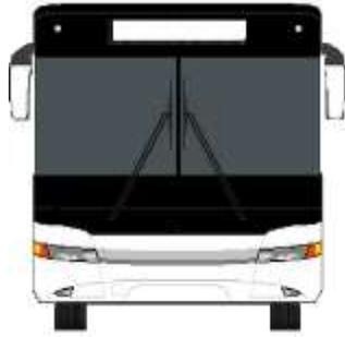
El vidrio se debe montar por el exterior del autobús y mantenerse en su lugar sujeto al hueco de la máscara delantera, mediante perfiles de hule (cañuelas) o pegado con adhesivo estructural, garantizando su fijación, alineación simétrica y estanqueidad permanente.
