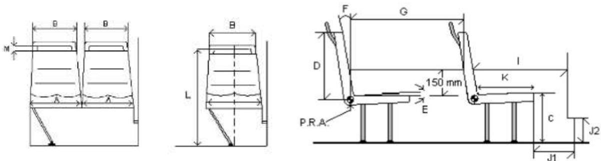
Los asientos en sus acabados deberán tener superficies redondeadas, y estar formados por una armadura metálica con base de perfiles tubulares de acero y una carcasa de material plástico polipropileno alto impacto inyectado, a efecto de evitar filos cortantes para el caso de accidentes.
