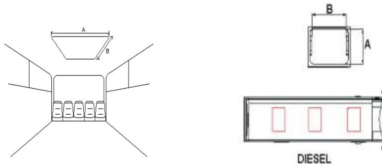
Las escotillas deberán ser de material TPO (Thermoplastic PolyOlefin), que se pueda aplicar el corte de color por el exterior de la unidad, con señalización para la operación, ventilación y para emergencia, según sea la necesidad, deberán contar con un mecanismo que permita la apertura y cierre de la misma sin mayores esfuerzos.
