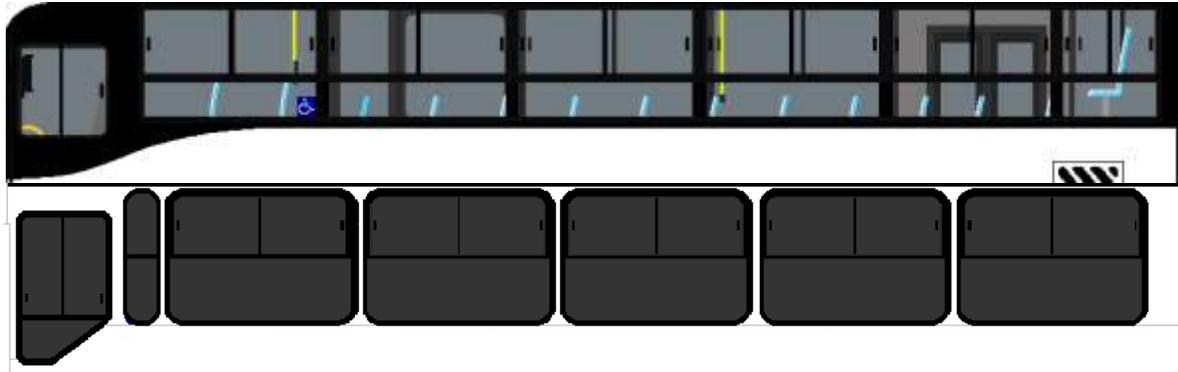
Cada ventanilla consistirá de dos partes, la inferior será de vidrios templados pegados a la estructura o sujeto al hueco de la estructura mediante perfiles de hule (cañuelas) y en la mitad superior en un marco de aluminio sujeto al vidrio inferior, con ventilas corredizas.
