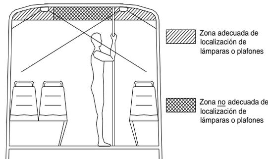
Los plafones deben ser de color blanco o translúcido, sin ningún filtro de color diferente a lo indicado anteriormente. El material debe ser acrílico, policarbonato o similar con características ignífugas, y que no derrame gotas de material quemado sobre asientos y pasillos y no generar gases tóxicos ni humo negro ni denso.
