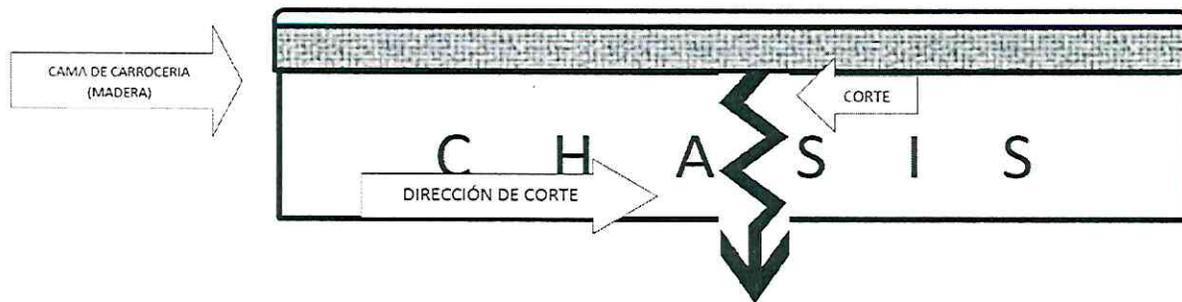
LA VISTA SUPERIOR REPRESENTA LA SECCIÓN DEL CHASIS DISPUESTA SOBRE LOS EJES DEL AUTOMOTOR, EN EL CUAL SE APLICARÁN CORTES PARA LA INHABILITACIÓN DE LAS UNIDADES INDICADAS EN LA PRESENTE LICITACIÓN. EN EL ESQUEMA SE MUESTRA DE IGUAL FORMA TANTO LA APLICACIÓN DE LOS CORTES, COMO LA DIRECCIÓN EN LA QUE LOS MISMOS SE LLEVARÁN A CABO. PROCEDER DE ESTA MANERA EVITARÁ QUE PRODUZCAN LOS ACCIDENTES DERIVADOS DE LA IGNICIÓN DE LOS MATERIALES QUE SE ENCUENTRAN EN LA VECINDAD DE LA ZONA CORTE.
